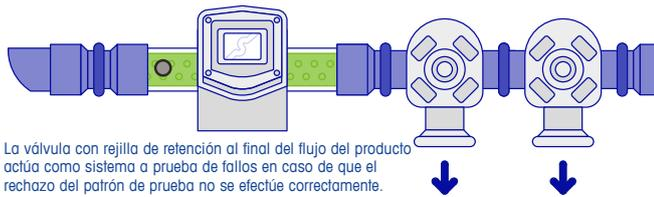
La válvula con rejilla de retención al final del flujo del producto actúa como sistema a prueba de fallos en caso de que el rechazo del patrón de prueba no se efectúe correctamente.
