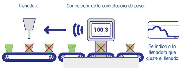
Figura 11.4: proceso de retroalimentación de la controladora de peso a la llenadora (paso 2)
