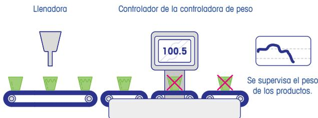
Figura 11.3: proceso de retroalimentación de la controladora de peso a la llenadora (paso 1)
