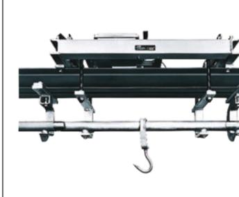
El sistema híbrido de brazo de palanca y célula de carga extensométrica digital permite retirar inserciones del raíl sin que las vibraciones afecten a los resultados. El soporte estándar de inserciones del raíl es adecuado para sistemas tubulares convencionales, mientras que el soporte universal y el platillo de adaptación garantiza una integración sencilla en numerosos tipos de sistemas de raíles.
