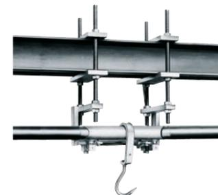
La báscula monorraíl DO300 está equipada con dos células de carga extensométricas y está diseñada para pesajes de hasta 300 kg. La unidad resistente y rígida antitorsiones se fija por debajo del soporte de montaje.
